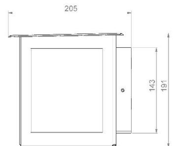
Die dreieckige Grundform dieser Leuchte hat einen historischen Ursprung und wird gerne an denkmalgeschützten Bauten eingesetzt. Der nach unten ausgerichtete Lichtaustritt ermöglicht eine optimale Ausleuchtung des jeweiligen Eingangsbereiches.
